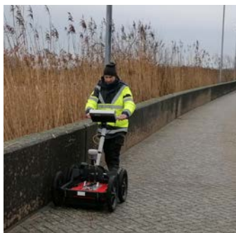
In kaart brengen van de holtes bij een dijk/kade om gerichte deep-injection te kunnen uitvoeren.
